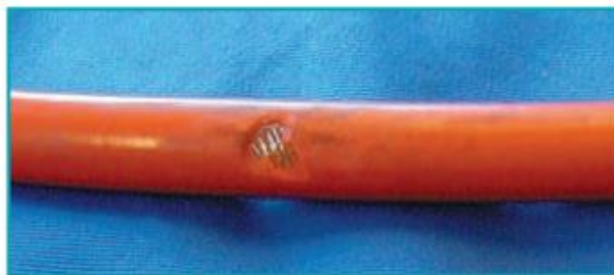
поврежденные шланги не использовать
