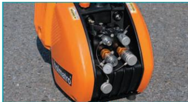
установка пылезащитных колпачков
