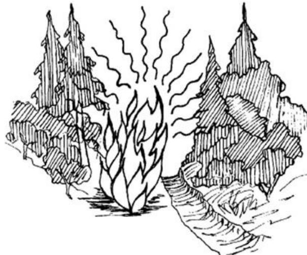
**Распространение огня через линию отсечки за счет конвекции**
