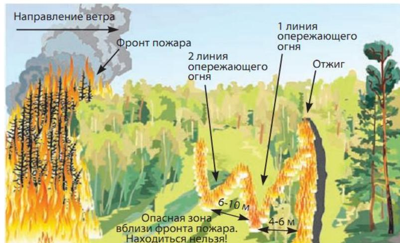
**При способе «гребенка»** поджигание покрова производят не только вдоль опорной полосы, но и перпендикулярно к ней через каждые 6 - 8 м. Длина отрезков перпендикулярного отжига может быть до 5 м.
