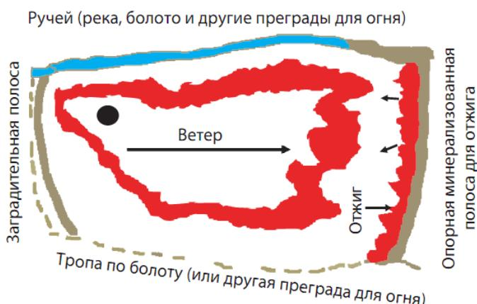
Отжиг - наиболее эффективный способ, применяемый при тушении верховых, а также низовых пожаров высокой и средней интенсивности. Этот способ позволяет быстро останавливать распространение таких пожаров небольшими по численности силами.
