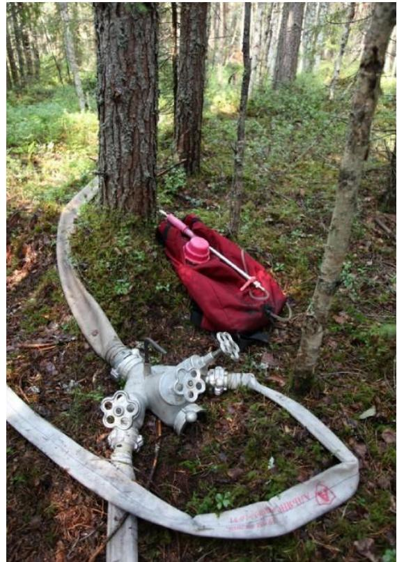
Расчет дальности подачи воды ведут в каждом отдельном случае на используемые насосы, диаметры насадок ствола и категории рукавов, ориентируясь на оптимальные параметры рабочей струи, выбрасываемой из пожарного ствола.
