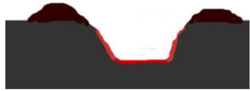
Пятый этап - заливка внутренней поверхности воронки и выброшенного грунта мощной струей из пожарных шлангов водой. При отсутствии дефицита воды можно всю воронку после взрыва залить водой из пожарной машины.
