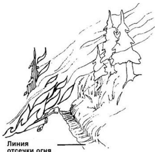
**Распространение огня через линию отсечки за счет теплового излучения**
