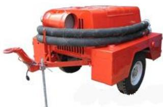
Предназначена для подачи воды из открытых водоисточников и ее перекачки. Подача воды - 1600 л/мин. Буксируется любым автомобилем с буксировочным устройством. Время работы на одной заправке топлива - 2.5 ч
