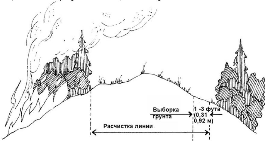
**Линия отсечки огня с демонстрацией линии расчистки и линии выбранного грунта**
