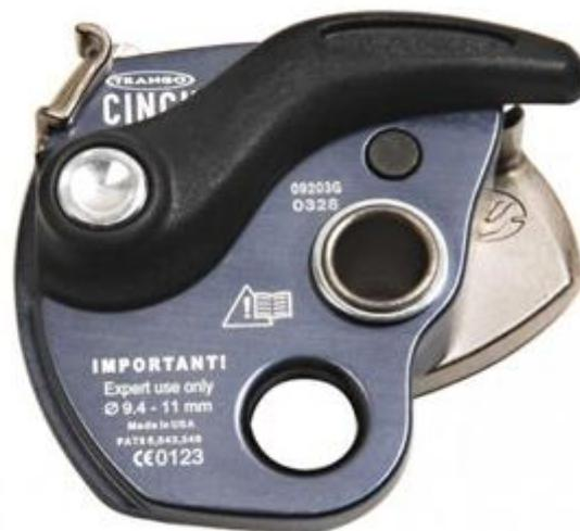
**Опасности:** поскольку при выдаче веревки для нижней страховки спусковой рычаг не используется, выдать веревку можно только в «открытом» положении устройства. Если держать Синч так, как показано в руководстве (рычаг с правой стороны и устройство находится ниже точки подвески), как показано на рис. 7, прямолинейное прохождение веревки сокращает трение почти до нуля. Даже при отчетливом рывке веревки, блокировки не происходит.
