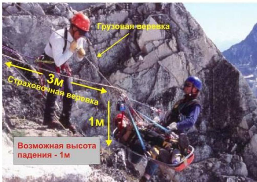
1.9.1. В итоге был разработаны следующие параметры теста для проведения испытаний СУ, предназначенных для страховки двух человек (груз 200 кг):
