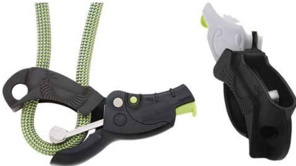
«пластины гида» - за счет прижима входящей ветви веревки выходящей ветвью – прим. пер.) Особенность Zap-O-Mat в том, что порог срабатывания блокировки можно переключать, приспособив устройство к диаметру используемой веревки: толстая веревка – большое усилие срабатывания, тонкая веревка – малое усилие.
