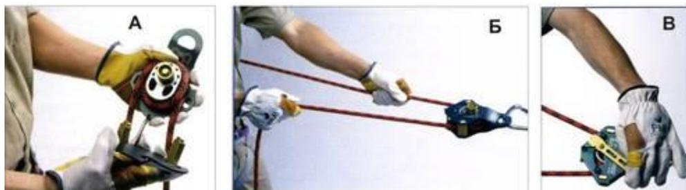
1.3. При спусках на большую глубину с использованием «540°™ Rescue Belay» также необходима организация дополнительного торможения (см. рис 11). В противном случае СУ начинает преждевременно «схватывать» страховочную веревку.
