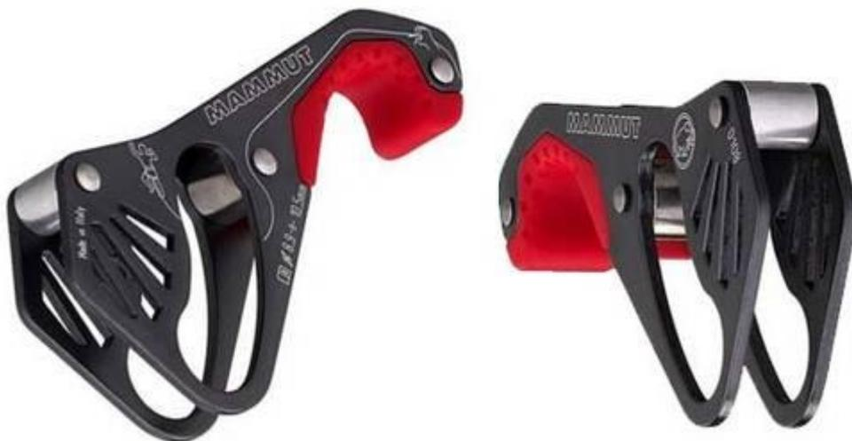
Конструктивно Smart очень прост и похож по принципу действия на описанный выше Click-Up. Карабин при рывке перемещается в щели и заклинивает выходящий конец веревки. По такому же принципу работают страховочные устройства Yo-Yo фирмы Camp и SRC фирмы Wild Country.
