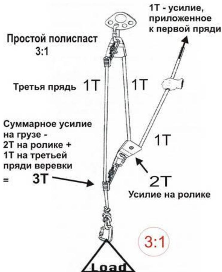
Приложив определенное усилие  $T$  к первой пряди веревки идущей к ролику (потери на трение здесь не учитываются) мы получим такое же усилие на второй пряди, выходящей из ролика. Результирующее усилие на ролике будет равно  $2T$ .
