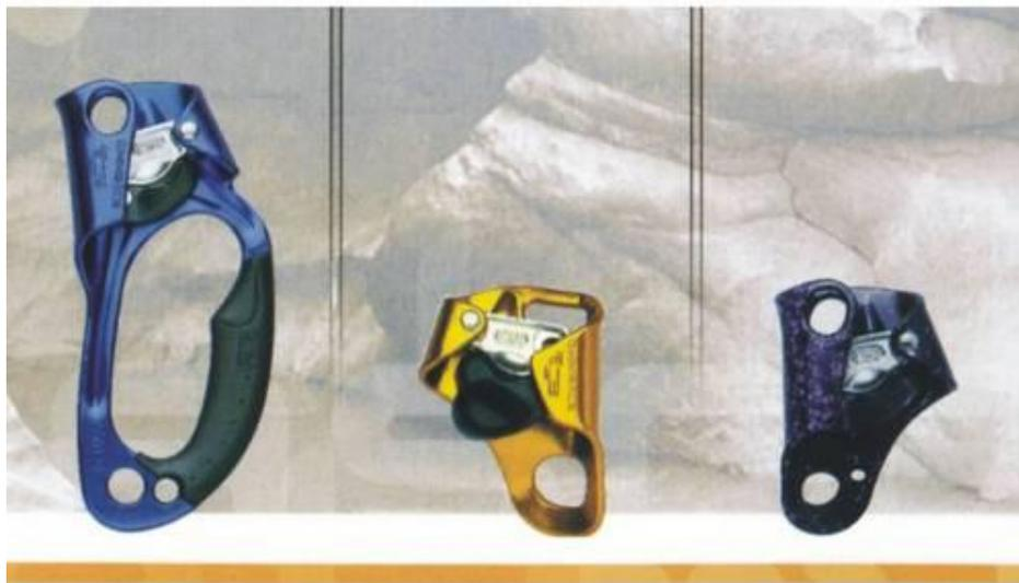
В случае использования зажима подобного типа, при внезапной перегрузке системы грузовая веревка будет серьезно «травмирована» или даже полностью перекушена, при гораздо меньших нагрузках по сравнению со схватывающим узлом: большинство таких зажимов начинает рвать оплетку при нагрузке порядка 4KN. И никакого сигнала SOS не будет!
