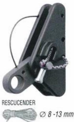
Существует много моделей подобных зажимов, но именно эта модель - Rescucender фирмы Petzl, чаще других используется спасателями. По данным испытаний, проводившихся в Англии в 2001г. этот зажим начинает ползти по веревке, умеренно травмируя оплетку, при статической нагрузке ~ 7KN.
