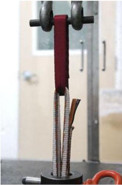
Рис. 15. Удлинение без узла – «петля в петле».
