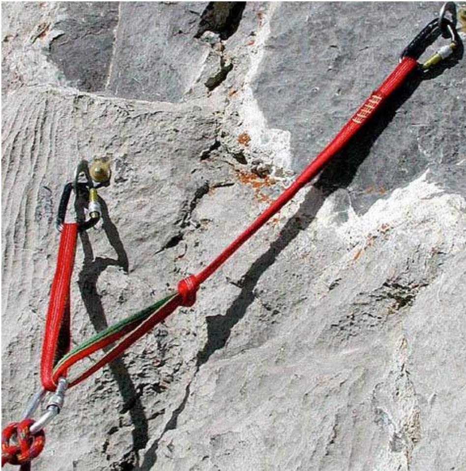
Рис. 34. Компенсационная петля с одним ограничительным узлом [2].
