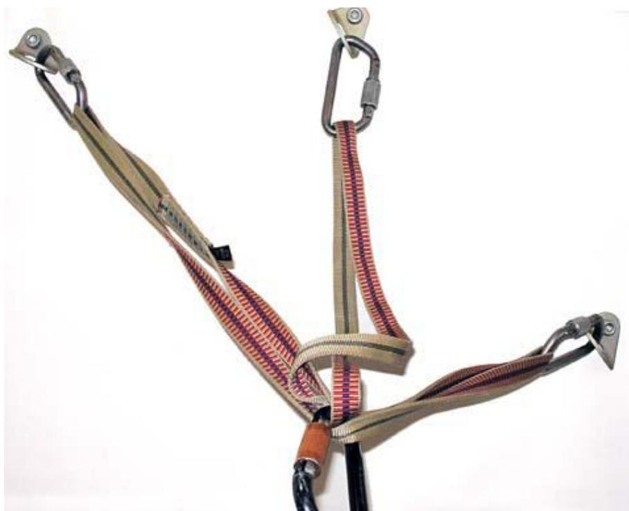
Рис. 47. «Заклинившаяся» под нагрузкой компенсационная петля.
