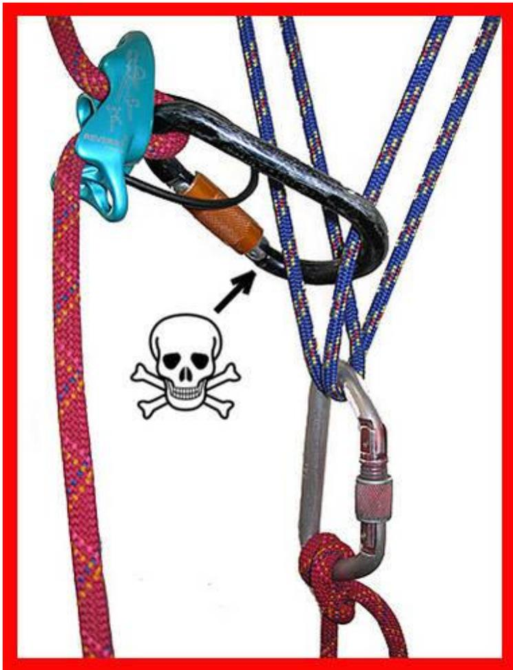
Рис. 75. Неправильное присоединение страховки и само страховки в компенсационную петлю.
