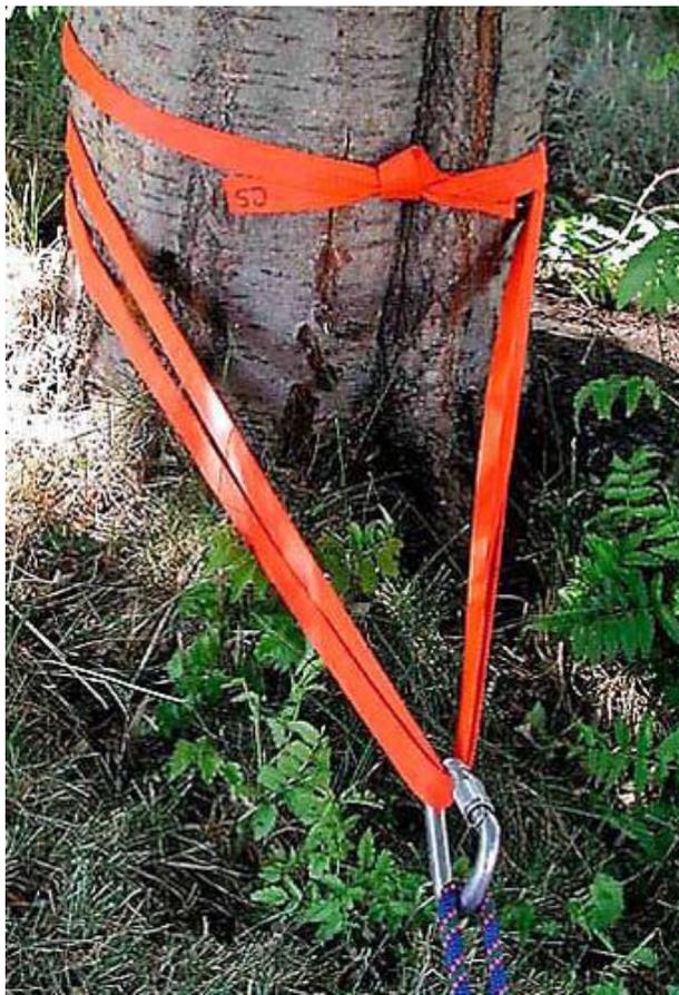
На рис. 9 показан очень надежный, но слишком трудоемкий способ для использования на обычных восхождениях; вариант хорош для спасательных ситуаций. Узел эффективно удален от точки приложения нагрузки, нагрузка распределена на четыре нити петли. Угол между ветвями петли небольшой, страховочный карабин нагружается правильно.
