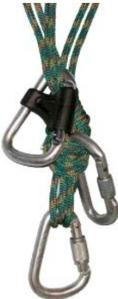
Рис. 8. Вспомогательные карабины в центральном пункте станции.
