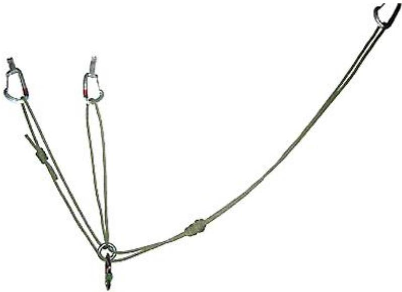
**Рис. 53.** ACR-станция на трех точках с ограничительным узлом [20].
