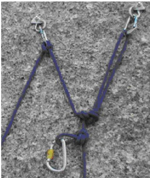
Рис. 17. Использование основной веревки связки для «параллельной» связи точек [8].
