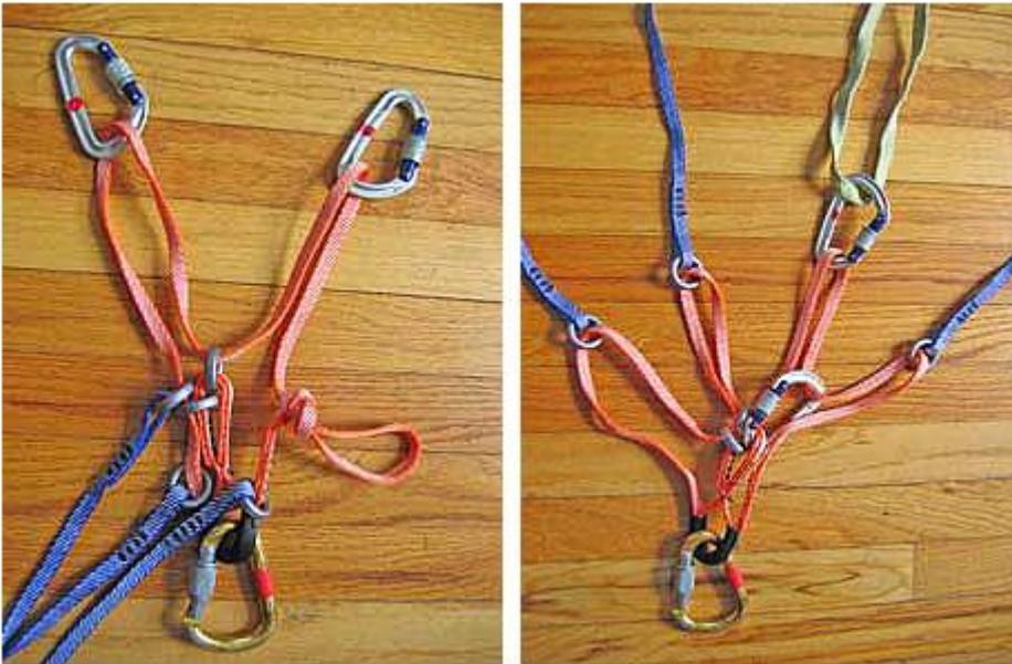
Рис. 62. «Геквалайзер» - объединение двух и четырех точек [15].
