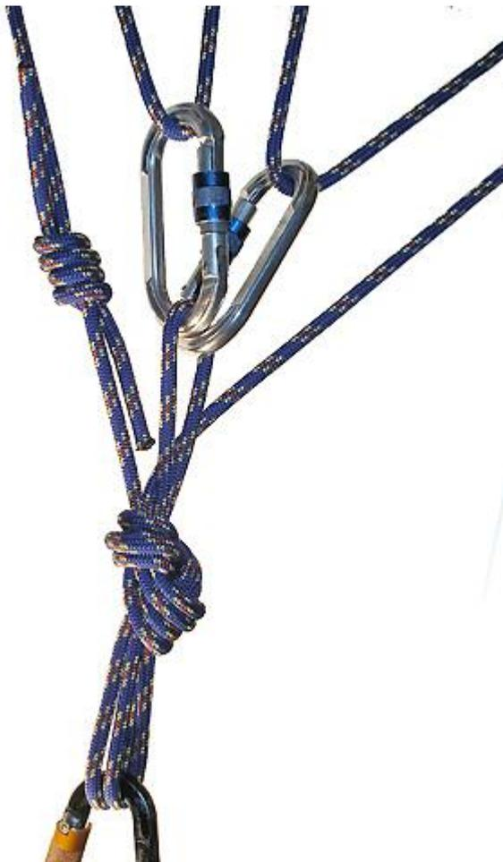
**Рис. 54.** Центральный пункт компенсационной петли на трех точках с дополнительными карабинами.
