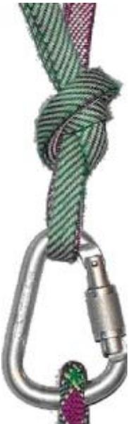
Рис. 20. Объединение двух петель общим узлом [2].
