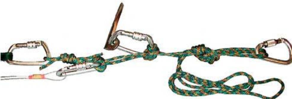
Рис. 64. Последовательная связь точек отдельной петлей [2].
