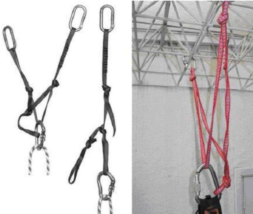
Рис. 39. Вариант «эквалетт» с одним карабином в центральном пункте станции.
