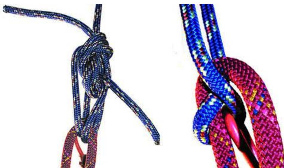
Рис. 32. Имитация вырывания одной точки при спуске на сдвоенной веревке (слева – итальянская петля, справа – обычная)
