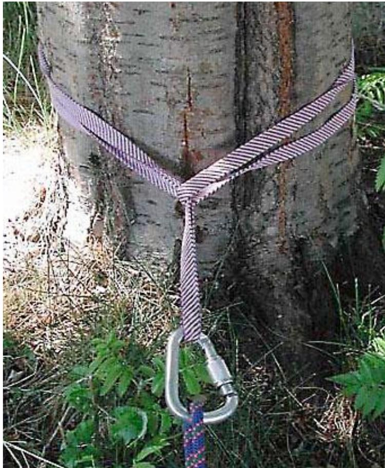
Узел «удавка» вокруг дерева ( Рис. 1) часто используется на практике, но фактически это - не лучший способ закрепления. По всей вероятности, он выдержит среднее падение, но при этом создается более высокая нагрузка в пункте, где стропа проходит через петлю, чем хотелось бы. Фактически, мы получаем мини-полиспасть, увеличивающей нагрузку на петлю, особенно при небрежном закреплении. Нагрузка распределяется только на две нити петли. Рассмотрим альтернативные способы.
