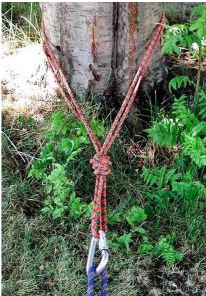
Рис. 5 - петля проходит вокруг дерева и связывается узлом восьмерка, чтобы создать пункт страховки. Это устраняет проблему нагрузки карабина по трем направлениям. Недостаток этого способа – трудно развязать затянувшийся под большой нагрузкой узел, чтобы снять петлю. Для облегчения развязывания, в узел можно вставить карабин, как показано на рис. 6.
