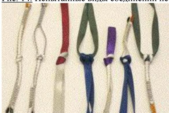
Общие выводы: материал, размер строп и их сочетание больше влияет на общую прочность, чем вид узла. При связывании более широкой нейлоновой стропы с узкими стропами из высокопрочных материалов, общая прочность снижается почти вдвое. При связывании узких строп из динемы и динекса общая прочность составила также около 55%.
