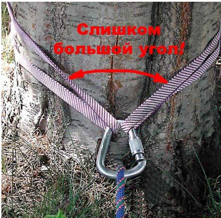
На рис. 2 хорошая идея испорчена плохим исполнением. Использована слишком короткая петля. В результате получился большой угол между ветвями петли и большая нагрузка на саму петлю. Если пошевелить карабин – есть риск нагрузить его в трех направлениях – рис. 3. При такой нагрузке, прочность карабина – около трети от номинальной.
