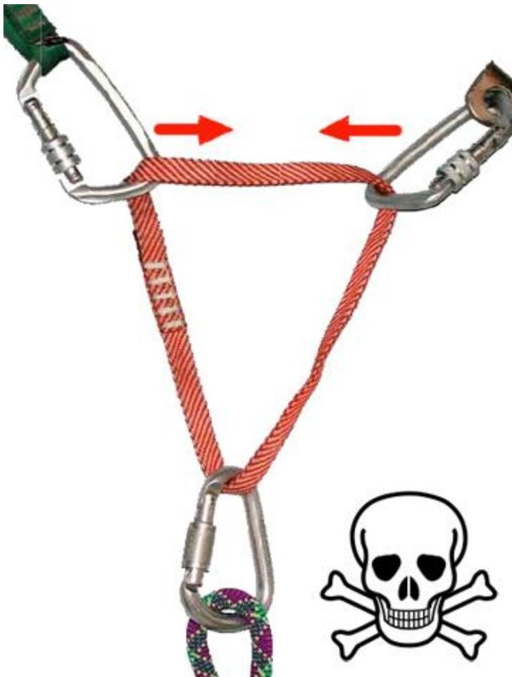
Рис. 41 «Смертельный треугольник»
