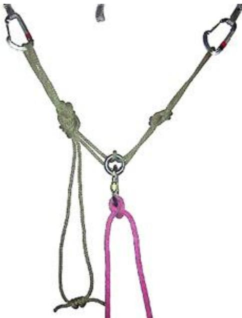
Рис. 51. ACR-станция на двух точках с ограничительными узлами [20].
