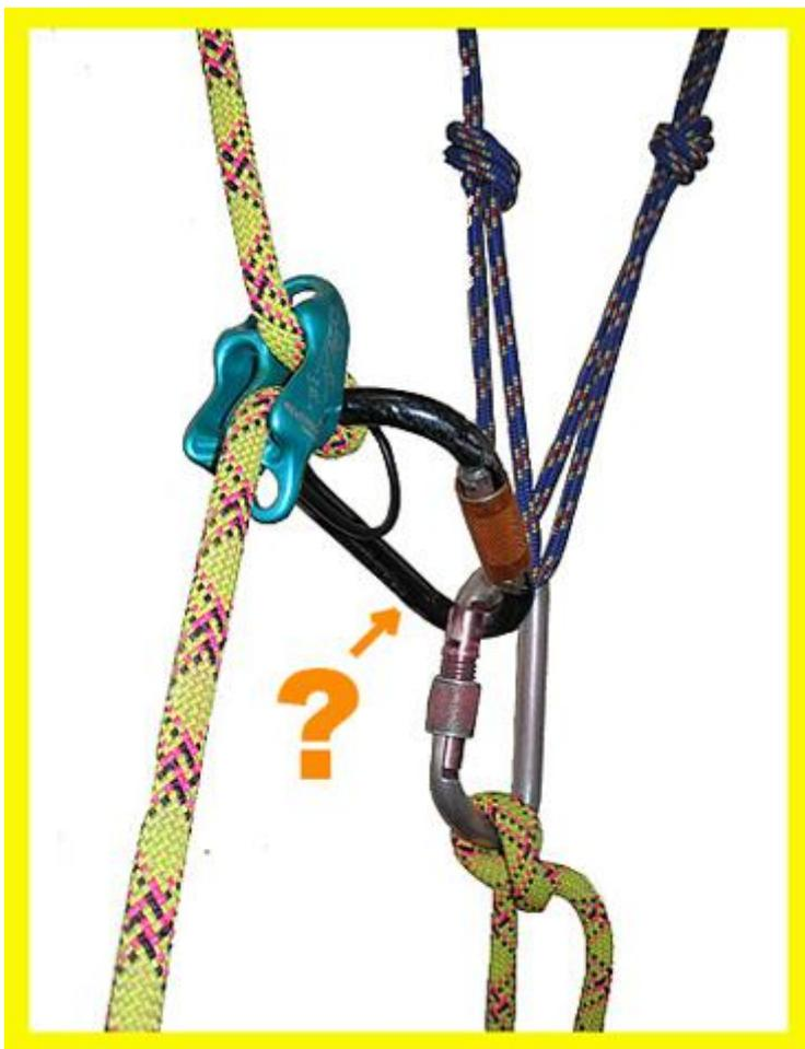
Рис. 76. Вариант присоединения страховки и само страховки к компенсационной петле.
