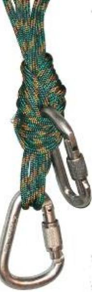
Рис. 6. Карабин в узле центрального пункта станции.
