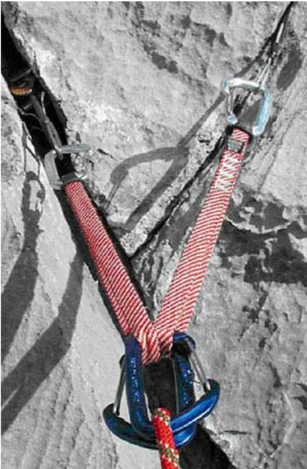
Рис. 19. Использование оттяжек для блокирования точек [2].
