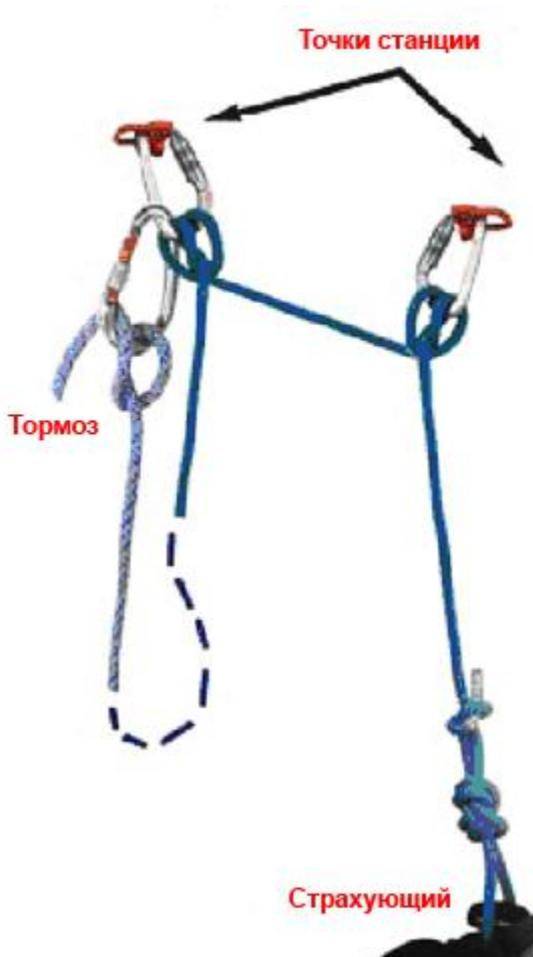
Рис. 16. Последовательное соединение двух точек основной веревкой [7].
